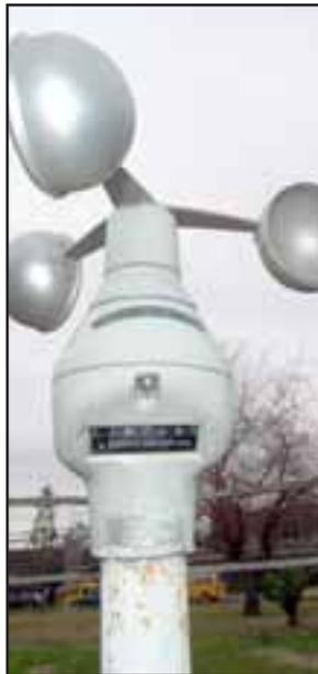
**El Anemómetro.** Este dispositivo registra la velocidad y dirección del viento.
