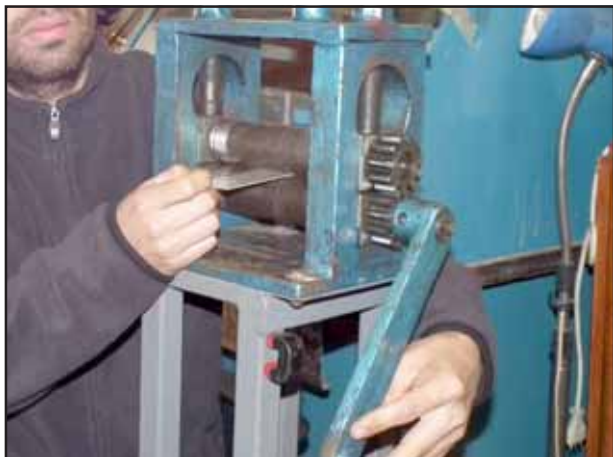
En esta máquina especial, Jorge Herrera logra laminar los metales con los que trabaja en su pequeño taller.
