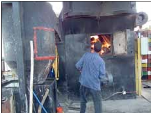
Este horno suministra todo el calor para seis túneles de tratamiento, aún estando a 800 grados, poca es la contaminación producida, gracias al filtro de agua a mano derecha que recibe todo el hollín que normalmente quedaría en la atmósfera.
