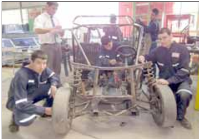
Este auto estilo 'buggy', fue fabricado por los estudiantes de Mecánica Automotriz de la Industrial.
