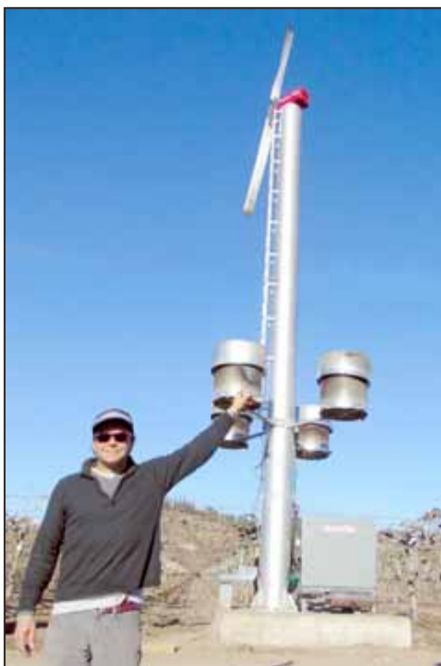
El empresario Esteban Lepe muestra a Diario El Trabajo la hélice que su empresa ha instalado a 300 metros de la población para contrarrestar las bajas temperaturas que afectan la fruta.
