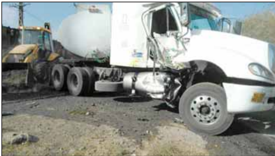
El camión sufrió considerables daños en su cabina y la rotura del estanque de combustible.
