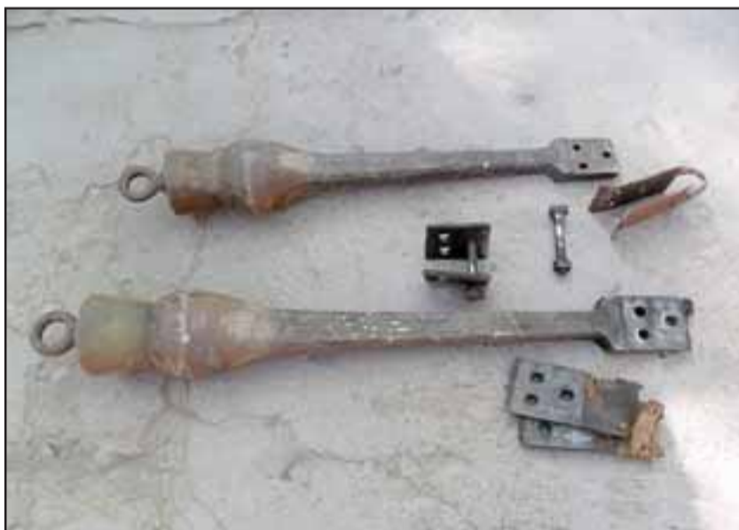
PIEZA POR PIEZA.- Estos badajos del reloj, así lucían antes de tener soportes de cuero. Un trabajo de reparación digno de un profesional.
