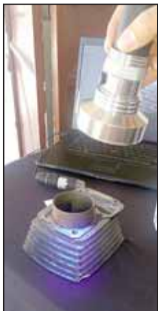
El sistema de micropuntos es una herramienta que funciona a través de un código alfanumérico que se adhiere a la superficie de los objetos a través de un adhesivo reactivo a la luz ultravioleta. Se pueden patentar computadores, autos, celulares, maquinarias, joyas, etc.
