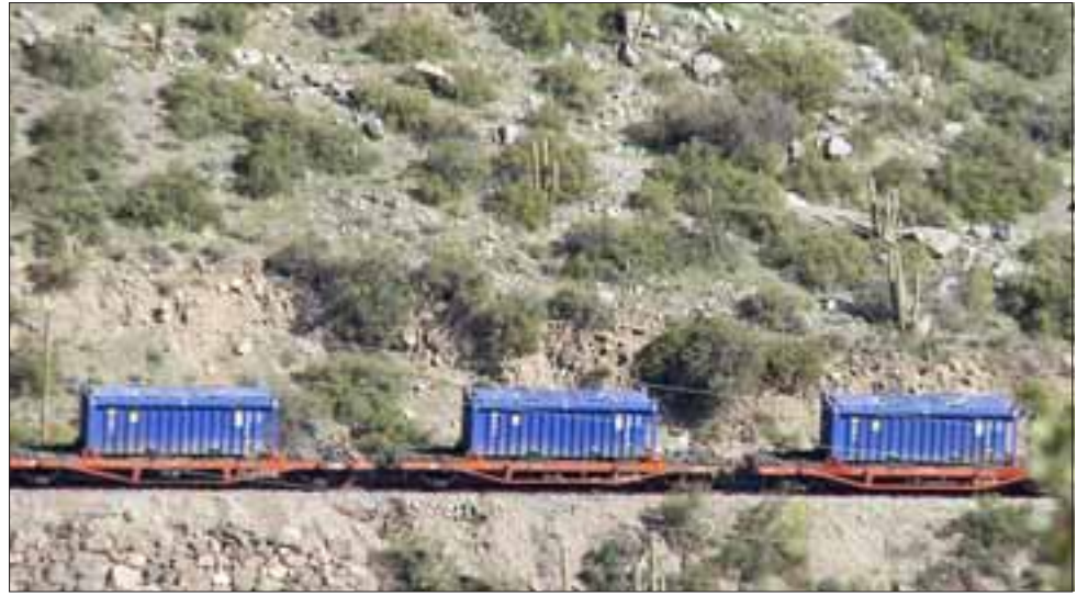
División Andina comenzó el recambio de sus antiguas ollas de transporte de concentrado por contenedores herméticos, que entregan una mayor seguridad a la operación.
