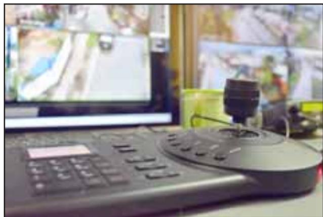
Las palancas de control permiten un manejo bastante preciso de las cámaras.
