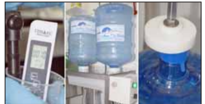
PROCESO DE ENVASE.- Medición de niveles químicos, lavado, llenado y sellado de recipientes de la mejor agua del Valle de Aconcagua.
