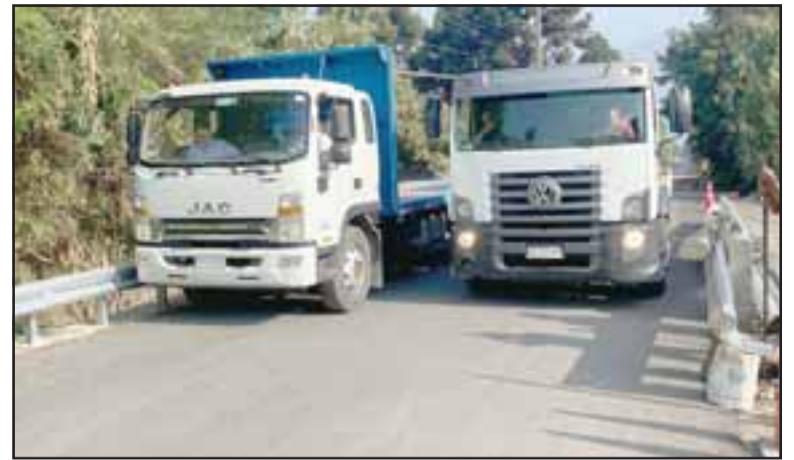
Para despejar todo tipo de dudas, se realizó una prueba en el nuevo puente Palayanque, donde se puso un vehículo menor al lado de un camión, como asimismo dos camiones, uno al lado del otro.
