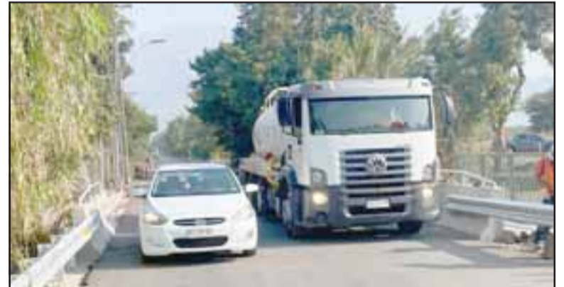
Para despejar todo tipo de dudas, se realizó una prueba en el nuevo puente Palayanque, donde se puso un vehículo menor al lado de un camión, como asimismo dos camiones, uno al lado del otro.
