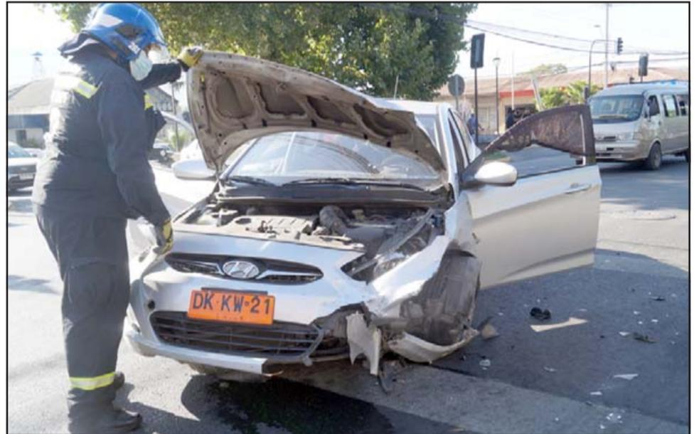
**EL PROTOCOLO.-** Este bombero desactiva la batería del radio taxi para evitar cualquier accidente eléctrico y posible combustión.
