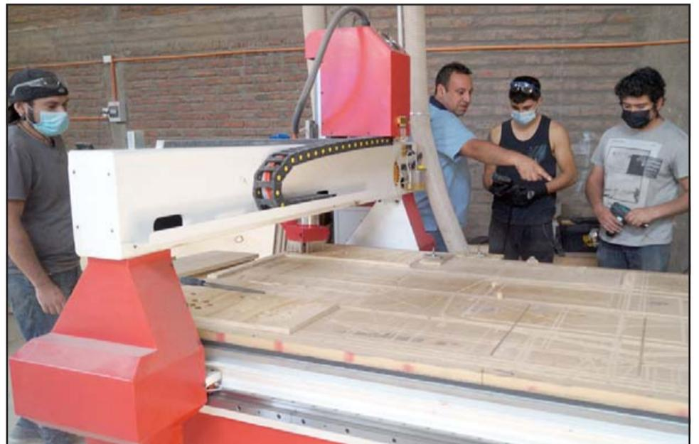
ROUTER DE PRIMERA.- Esta máquina corta la madera que se usa para el mueble de las consolas, todo es automatizado.
