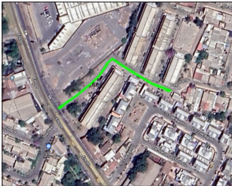
La franja verde corresponde al sector a pavimentar, una 'L' de 156 metros lineales desde la entrada hasta el último de los blocks de departamentos.
