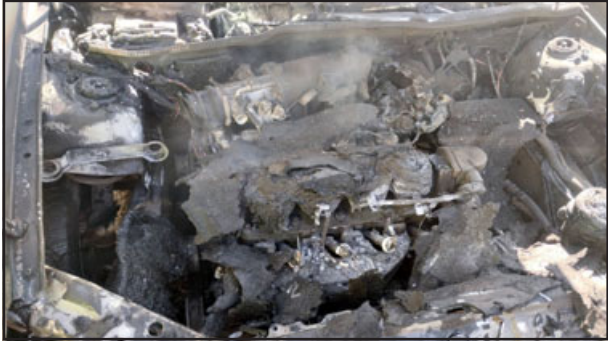
Una imagen más cercana del estado en que quedó el motor tras el incendio.
