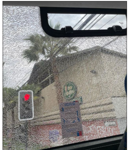
En la imagen se puede apreciar el vidrio trizado producto de la pedrada.
